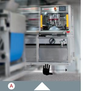
Der BAGinBOX Abfüller ist Dank Schwerlastschienen ausziehbar und bietet somit mehr Arbeitsfläche bei der Befüllung des Saftes. Die Abfüllstation wird nach dem Ausziehen mit einem Stützfuß fixiert.
