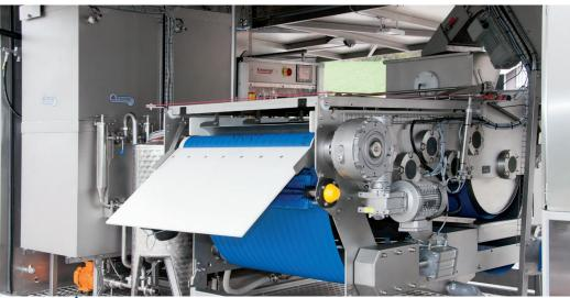
Unsere Bandpresse vereint innovative Presstechnik und hohe Leistung mit einfacher Bedienung. Die Maische wird durch den einstellbaren Dosierkasten gleichmäßig auf das Siebband aufgetragen und am Ende durch einen Abstreifer vom Pressband gelöst.
