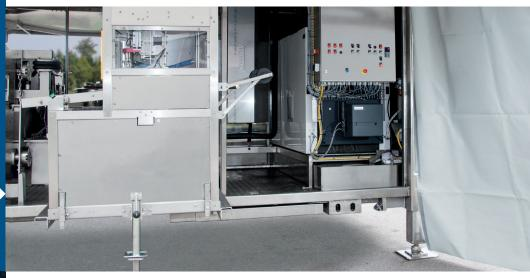
Nachdem ein Bag in die Arretierung eingelegt und der Zapfhahn entfernt wurde, wird die Abfüllstation über die Öffnung des Bags geschwenkt und der Startknopf gedrückt. Die voreingestellte Menge wird mit einer Füllpumpe in den Bag gedrückt.
